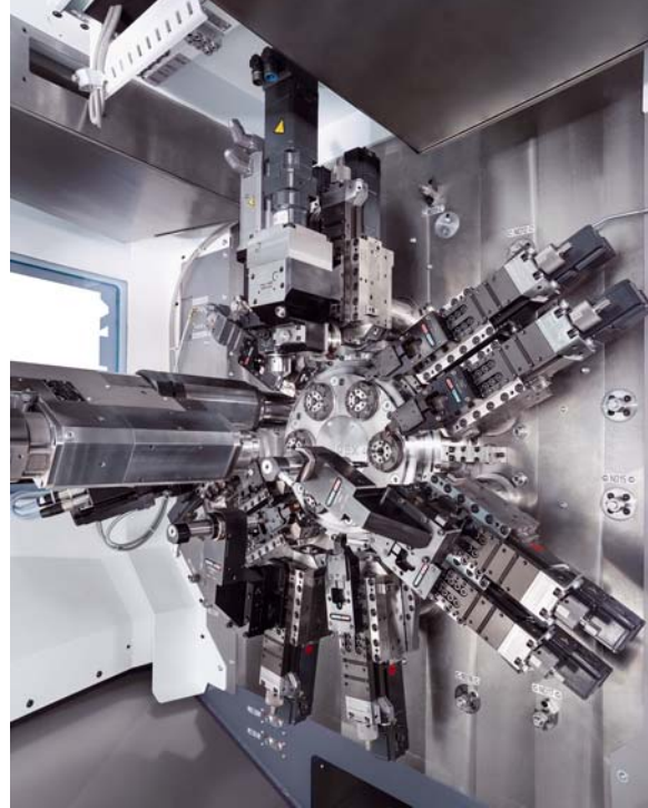
Schlitten-Schnellspannsystem mit W-Verzahnung: Mit dieser Index-Entwicklung lassen sich Werkzeughalter ohne kompliziertes Ausrichten in kürzester Zeit rüsten. Die exakte Ausrichtung ist in der W-Verzahnung des Schlittens und den positiven Zähnen des Werkzeughalters schon vorgegeben. Bild: Index
