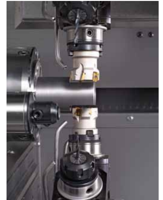
Y-Funktionalität an beiden Werkzeugrevolvern: Fräsbearbeitung von Flächen (Y-Weg +/- 50 mm)
